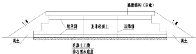
图 4.4.1 填土类保护壁断面示意（坡率 M 由设计定）
